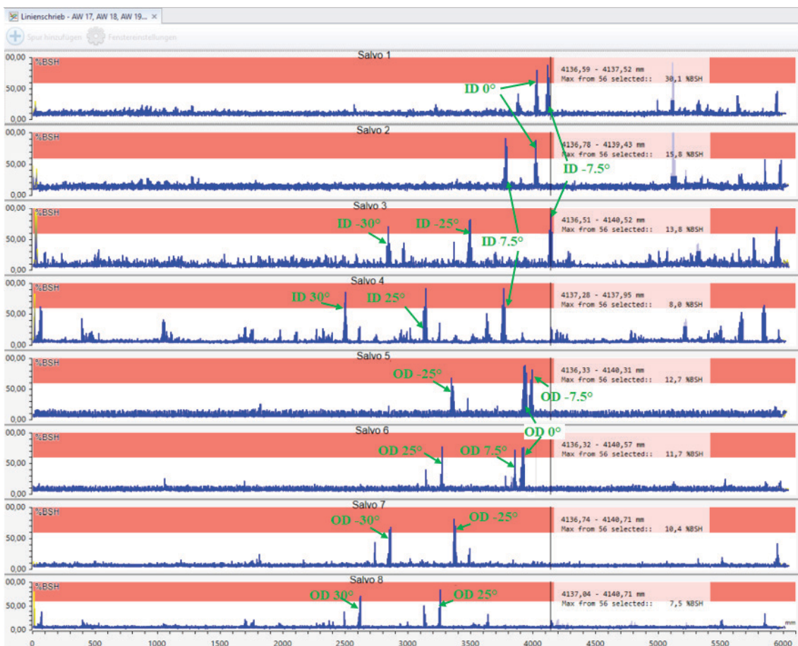
Abb. 8. Schrägfehlerprüfung bis \pm 30^\circ mit Cluster 1 und zwei Prüfköpfen in dickwandigem Testrohr
