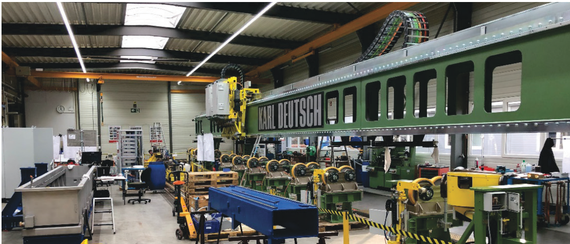
Abb. 11. ECHOGRAPH-RPTR-PAUT-Prüfbrücke (rechts) während der Montage bei KARL DEUTSCH in Wuppertal (links im Bild ein ECHOGRAPH-TTPS-Tauchtankprüfsystem während des Zusammenbaus)
