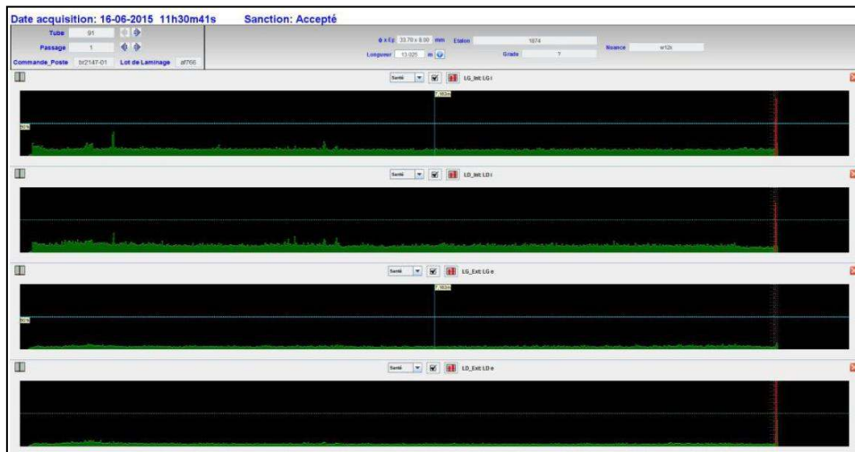
Figure 22 - Inspection d'un tube de production (sans défaut) sur Lineview
