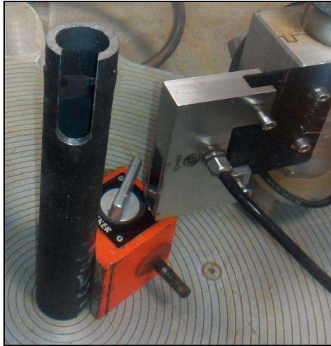
Figure 10 - Montage mécanique dans la cuve à eau. Une ouverture est faite afin de pouvoir usiner l'entaille interne.
